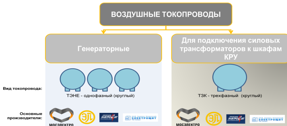
Рисунок 2. Типы воздушных токопроводов
